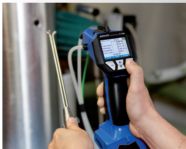
Detail Messsonde für Ventilationsverlust
